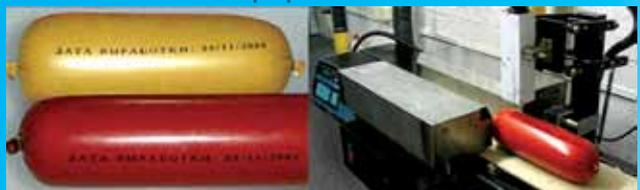
Предназначен для перемещения и маркировки батонов колбасы и др. продукции
