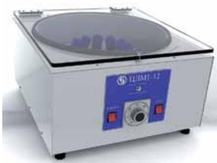
Центрифуга имеет встроенный нагревательный элемент и предназначена для определения массовой доли жира в молоке и молочных продуктах по ГОСТ 5867 и массовой доли белка в молоке по ГОСТ 25179, а также для измерения растворимости сухих молочных продуктов по ГОСТ 8764.
